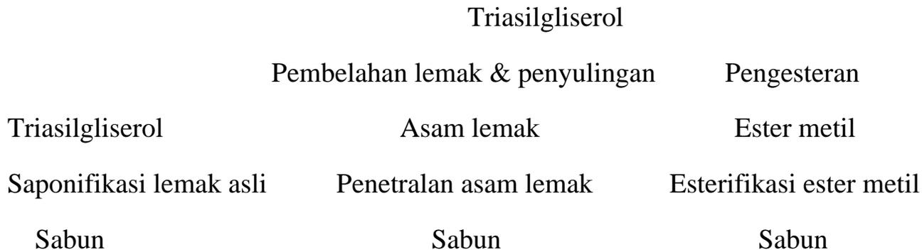
**Gambar 6.1 Flow Diagram Pembuatan Sabun**
